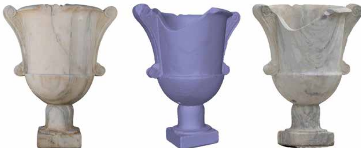
Fig 11. A digital still image (left), untextured mesh (middle), and textured mesh (right). Sl. 11. Digitalna slika (lijevo), mreža bez teksturom (sredina), i mreža sa teksturom (desno).
